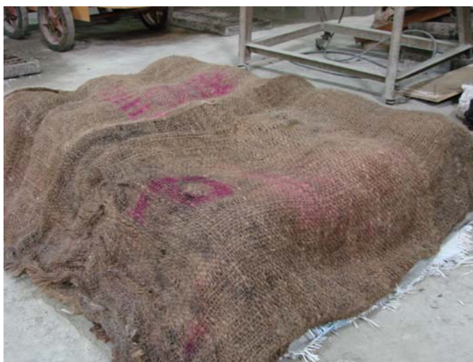
ภาพที่ 21 กระสอบเปียกน้ำคลุมตัวอย่างคอนกรีตควบคุม เพื่อป้องกันการระเหยของน้ำ
