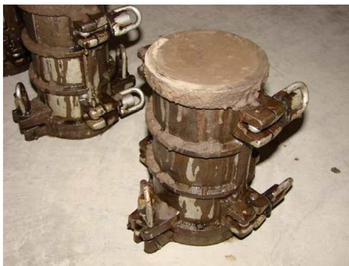
ภาพที่ 15 ตัวอย่างจีโอโพลิเมอร์คอนกรีต
