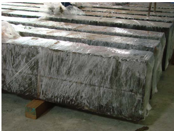
ภาพที่ 34 ตัวอย่างคานจีโอโพลิเมอร์คอนกรีตและคานคอนกรีตควบคุมหลังจากการบ่ม และเก็บไว้ในอุณหภูมิปกติ
