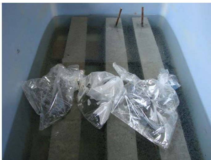
ภาพที่ 33 การบ่มคานคอนกรีตควบคุม
