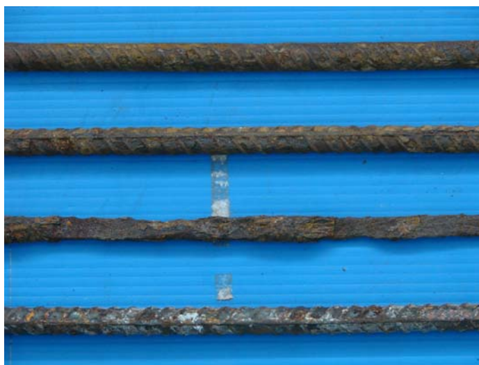
ภาพที่ 26 การลดลงของพื้นที่หน้าตัดของเหล็กเสริมเนื่องจากการเกิดสนิมของตัวอย่างรูปทรงกระบอก
