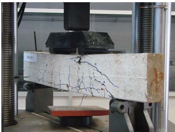
ภาพที่ 36 การทดสอบกำลังรับแรงดัดของตัวอย่างคานจีโอโพลิเมอร์คอนกรีตและคานคอนกรีต ควบคุม
