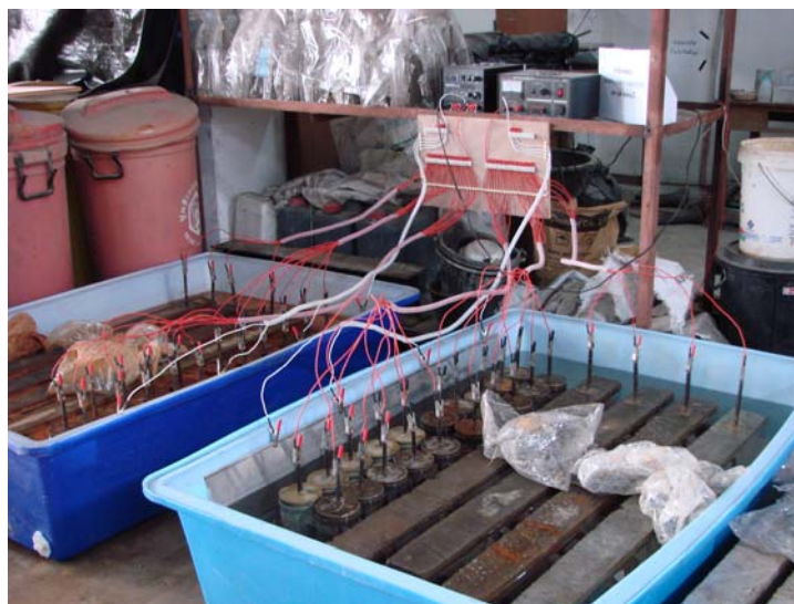
ภาพที่ 23 การเร่งการเกิดสนิมของเหล็กเสริมด้วยศักย์ไฟฟ้า 6 โวลต์
