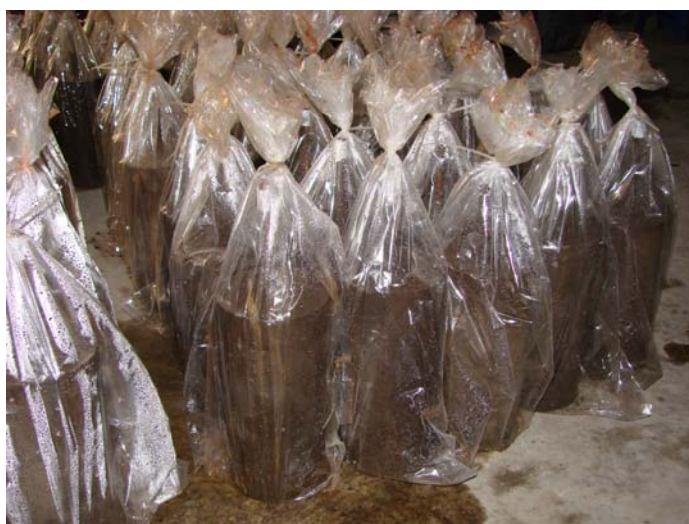
ภาพที่ 20 ตัวอย่างจีโอโพลิเมอร์คอนกรีตหลังจากการบ่ม และเก็บไว้ในอุณหภูมิปกติ
