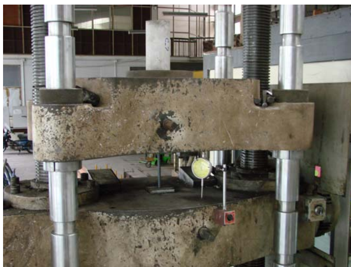
ภาพที่ 25 การทดสอบกำลังการยึดเหนี่ยว
