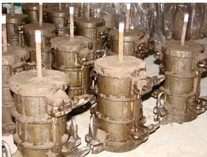
ภาพที่ 17 จีโพลิเมอร์คอนกรีตที่เสียบเหล็กเสริมบริเวณกลางตัวอย่าง
