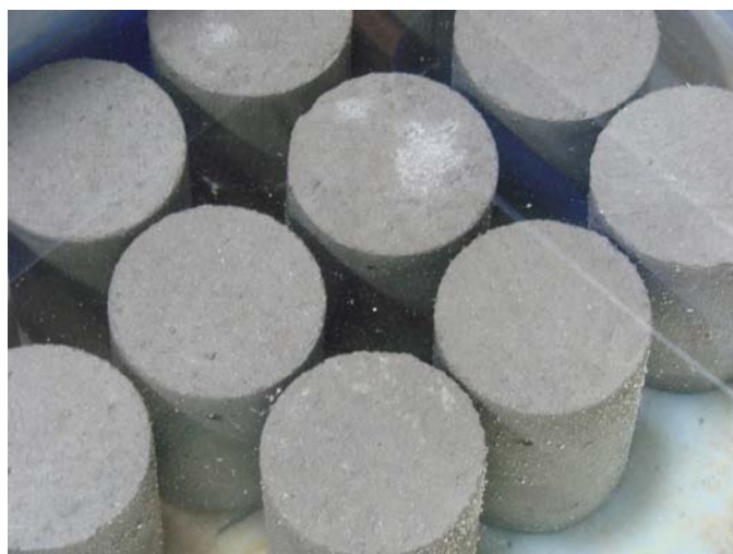
ภาพที่ 22 การบ่มตัวอย่างคอนกรีตควบคุมด้วยน้ำ
