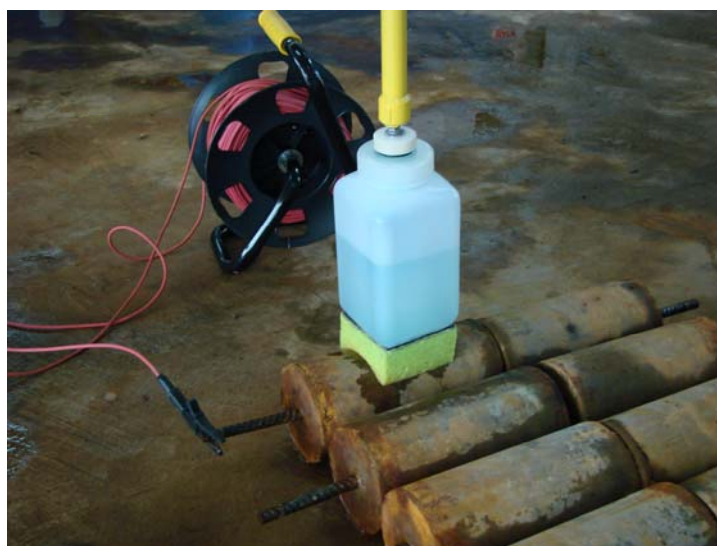
ภาพที่ 24 การวัดค่าความต่างศักย์ไฟฟ้าครึ่งเซลล์ตัวอย่างรูปทรงกระบอก
