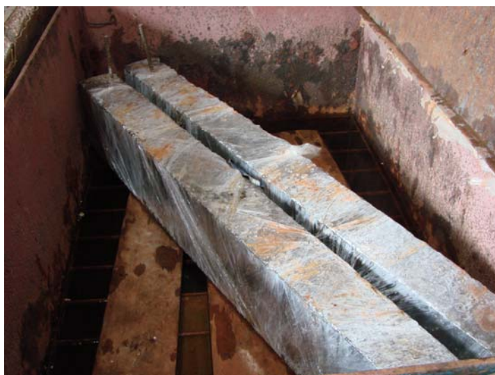
ภาพที่ 32 การบ่มคานจีโอโพลิเมอร์คอนกรีต
