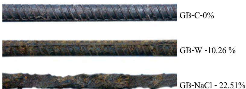
ภาพที่ 47 การกัดกร่อนของเหล็กเสริม
