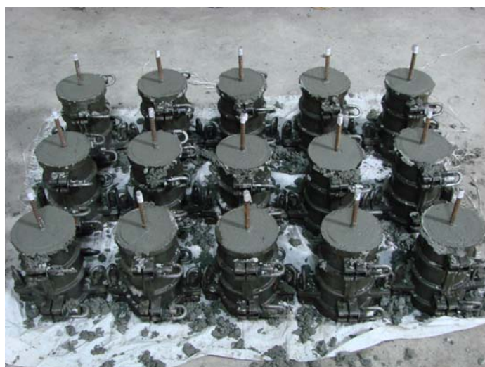
ภาพที่ 18 คอนกรีตควบคุมที่เสียบเหล็กเสริมบริเวณกลางตัวอย่าง
