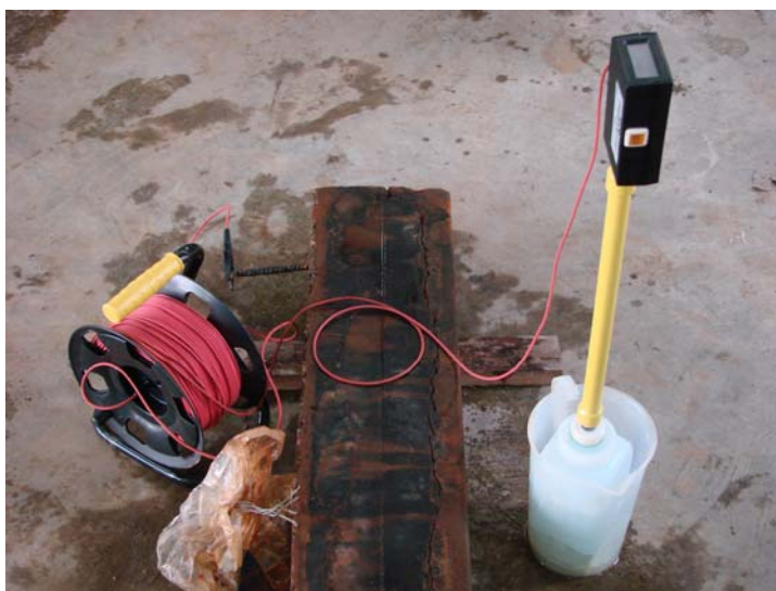
ภาพที่ 35 การวัดค่าความต่างศักย์ไฟฟ้าครึ่งเซลล์ตัวอย่างรูปคาน
