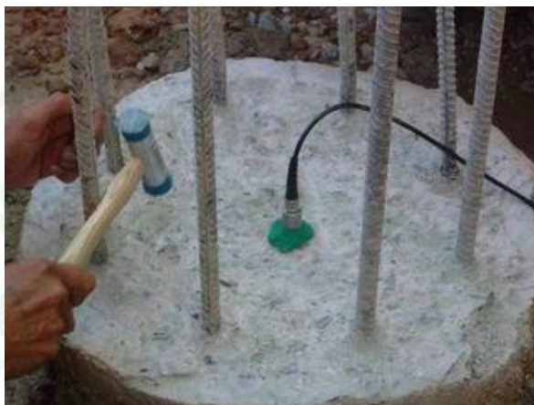
ภาพที่ 28 การใช้ค้อนเคาะลงบนหัวเสาเข็มทดสอบ
