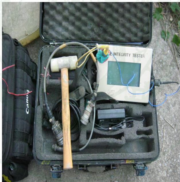
ภาพที่ 35 เครื่องมือทดสอบ P.I.T Collector ,ตัวรับสัญญาณความเร่ง (Accelerometer) และค้อนที่ได้รับการออกแบบเป็นพิเศษ (Hand Held Hammer )
