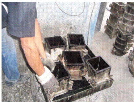
ภาพที่ 21 การเก็บก้อนตัวอย่างคอนกรีตเพื่อนำไปทดสอบกำลังอัด
