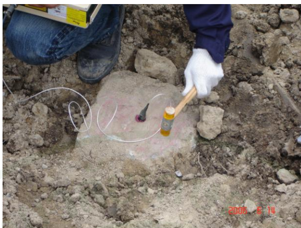
ภาพที่ 44 แสดงการทดสอบการใช้ก้อนเคาะที่ผิวเสาเข็ม
