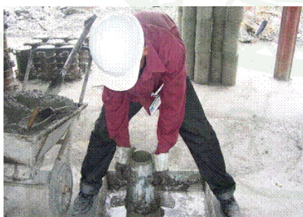
ภาพที่ 20 การตรวจสอบความขึ้นเหลว(Slump) ของคอนกรีตที่ใช้หล่อเสาเข็ม
