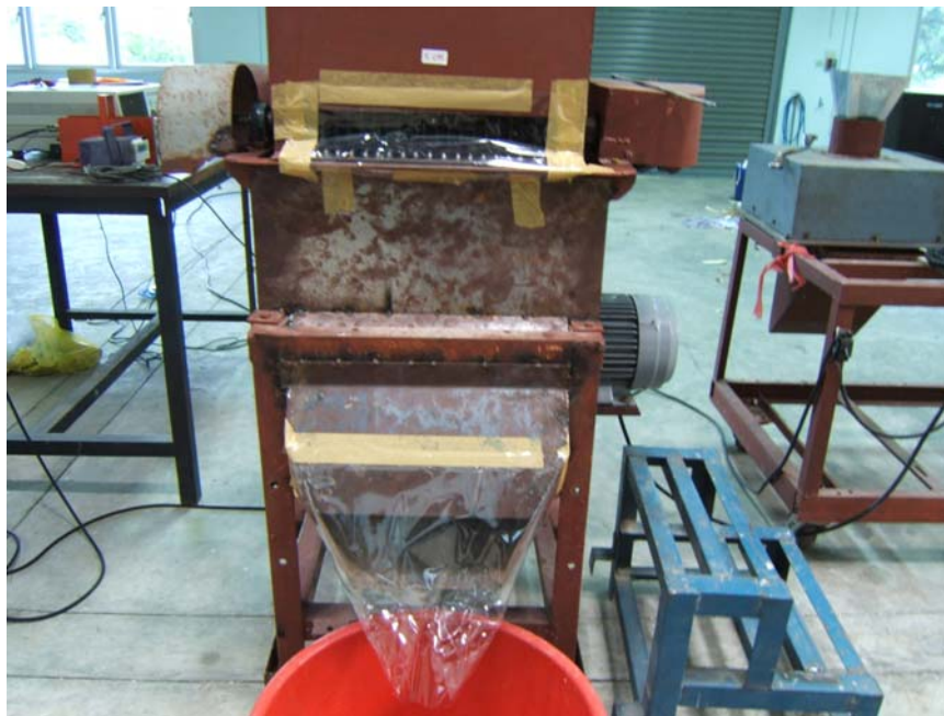
ภาพที่ 34 การติดตั้งเครื่องวัดกับเครื่องตัดหัวมันลำปะหลังสดตามแนวตั้งฉากกับแนวแกน
