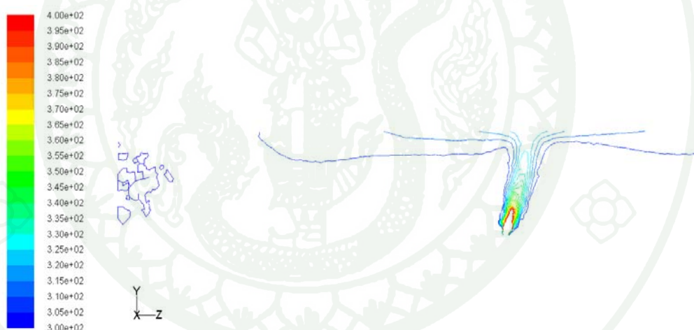
ภาพที่ 34 การกระจายตัวของความร้อนในเวลา 30 วินาทีหลังจากการให้ความร้อนกับแหล่งความร้อน
