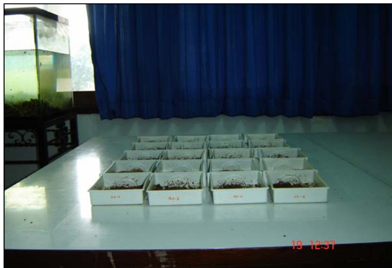
ภาพผนวกที่ ข3 กล่องพลาสติกสำหรับการบำบัดกากตะกอนแห้งโดย Eudrilus eugeniae
