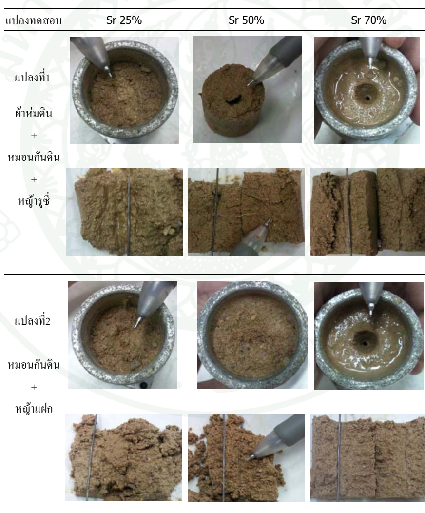
ภาพที่ 79 ลักษณะของตัวอย่างหลังจากทดสอบ Pinhole Test เสร็จของดินแปลงที่ 1 และ 2 ที่ระดับความอิ่มตัวของน้ำ ( S_r ) ต่างๆ
