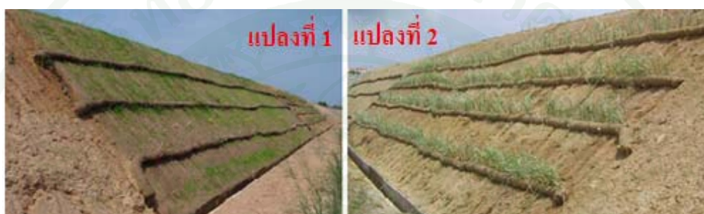
ภาพที่ 33 แปลงทดสอบที่ 1 (ผ้าห่มดิน) และแปลงทดสอบที่ 2 (หญ้าแฝก)
