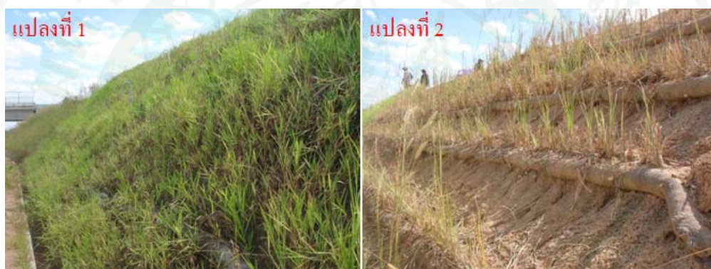
ภาพที่ 88 การเปรียบเทียบการกัดเซาะที่เกิดขึ้นจริงในสนามของทั้ง 2 แปลงทดสอบ วันที่ 7 มีนาคม 2553 ภายหลังการติดตั้งฝ้าห่มดินและหมอนกันดินร่วมกับการปลูกพืช
