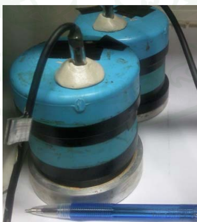
ภาพที่ 36 แสดงการวัดแรงดูดน้ำในดินโดยใช้ Relative humidity sensor
