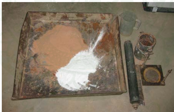
ภาพที่ 29 แสดงอุปกรณ์สำหรับบดอัดดินและตัวอย่างดินที่จะทำการบดอัด
