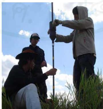
ภาพที่ 38 แสดงการทดสอบ Kunzelstab penetration test
