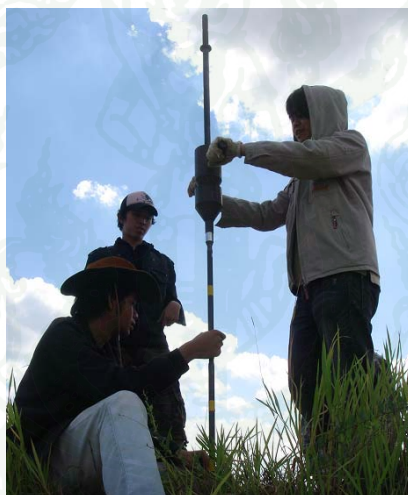
ภาพที่ 81 แสดงการทดสอบ Kunzelstab penetration test
