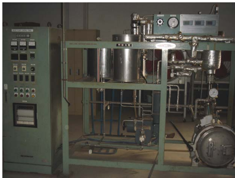
ภาพผนวกที่ ค1 แสดงเครื่องระเบิดด้วยไอน้ำของบริษัท Kitto Koatsu ประเทศญี่ปุ่น ชนิดทำงานเป็นครั้ง (batch) ขนาดความจุ 2.5 ลิตร
