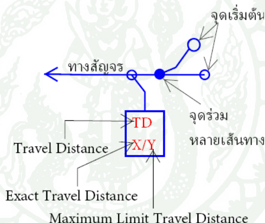
ภาพที่ 16 แสดงสัญลักษณ์ผลการวัดระยะทางสัญจรที่แสดงในแบบ
