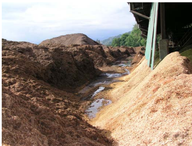
ภาพที่ 28 น้ำท่วมขังบริเวณถังจัดเก็บเชื้อเพลิงชีวมวลและเชื้อเพลิงชีวมวลล้นออกนอกถัง
