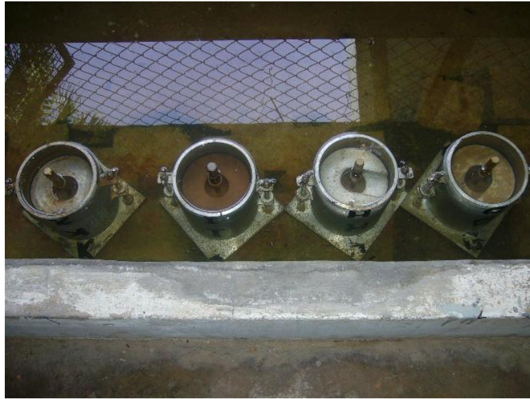
ภาพผนวกที่ ข2 การทดสอบ CBR แบบแช่น้ำ (Soaked)
