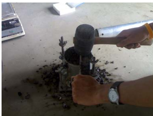
ภาพผนวกที่ ข1 การทดสอบ Compaction Test แบบสูงกว่ามาตรฐาน
