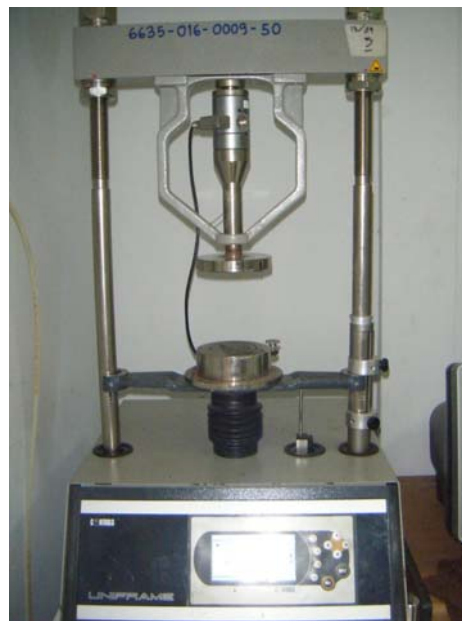
ภาพผนวกที่ ข3 เครื่องมือทดสอบ Unconfined Compression Strength (UCS)
