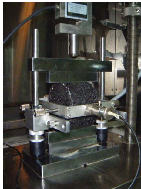
ภาพที่ 25 การติดตั้งก่อนตัวอย่างก่อนทดสอบ Resilient Modulus ( M_R )
