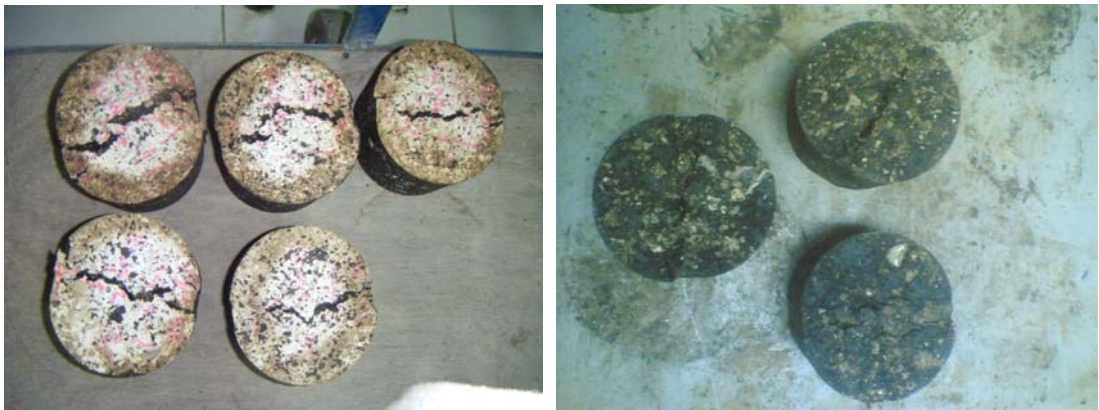
ภาพผนวกที่ ข6 ความเสียหายของก้อนตัวอย่างหลังการทดสอบ Indirect Tensile Test
