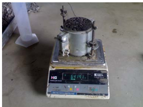
ภาพผนวกที่ ข1 การทดสอบ Compaction Test แบบสูงกว่ามาตรฐาน
