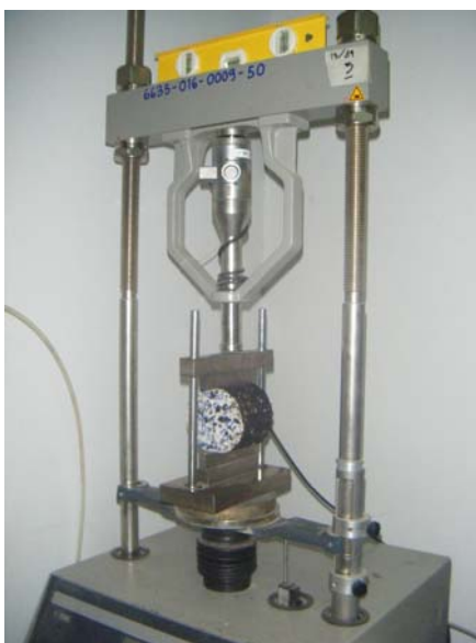
ภาพที่ 22 การติดตั้งก่อนตัวอย่างก่อนทดสอบความต้านทานแรงดึงทางอ้อม (Indirect Tensile Test)
