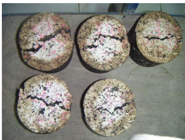
ภาพที่ 23 ก่อนตัวอย่างหลังการทดสอบความต้านทานแรงดึงทางอ้อม (Indirect Tensile Test)
