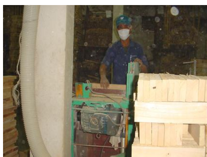
ภาพที่ 2.26 การป้องกันฝุ่นของไม้โดยการติดตั้งเครื่องดูดฝุ่นเข้าสู่ ไซโล ด้านหลังโรงงาน
