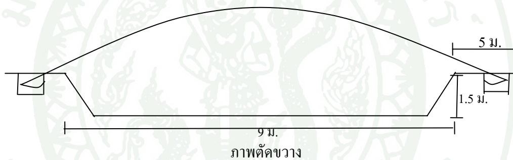
ภาพที่ 5 ลักษณะโครงสร้างของระบบบำบัดน้ำเสียแบบบ่อดินปิดคลุมด้วยพลาสติก ที่มา: จากการสำรวจ
