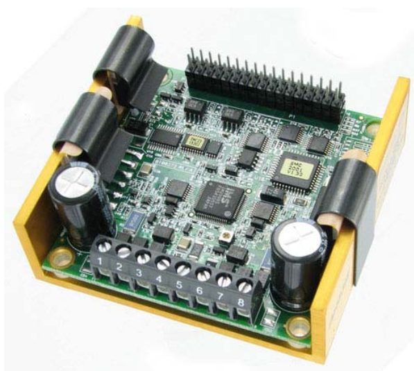
รูปที่ 4.5 รูปถ่ายแสดงโครงสร้างและส่วนประกอบของไดรเวอร์สเต็ปมอเตอร์รุ่น IM483i
