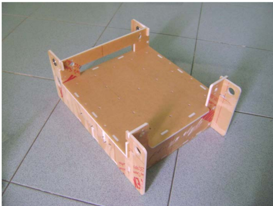
รูปที่ 3.14 แสดงส่วนของโครงสร้างของเครื่องและแกน Y ที่ประกอบกันเสร็จเรียบร้อยแล้ว
