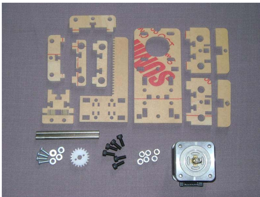
รูปที่ 3.19 แสดงชิ้นส่วนของส่วนที่ยึดหัวเลเซอร์ เป็นแผ่นอะครีลิคหนา 5 mm.
