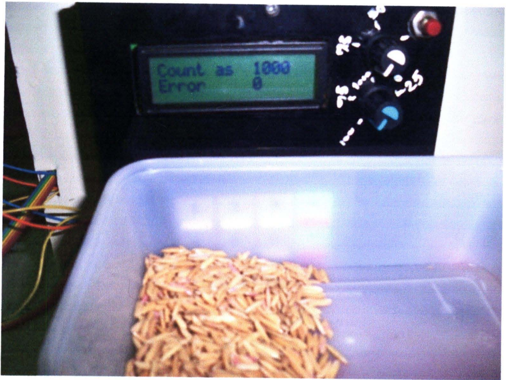
ภาพที่ ข.5. เครื่องจะแสดงผลทำงานนับเมล็ดข้าว หลังจากนับเมล็ดจนครบ
