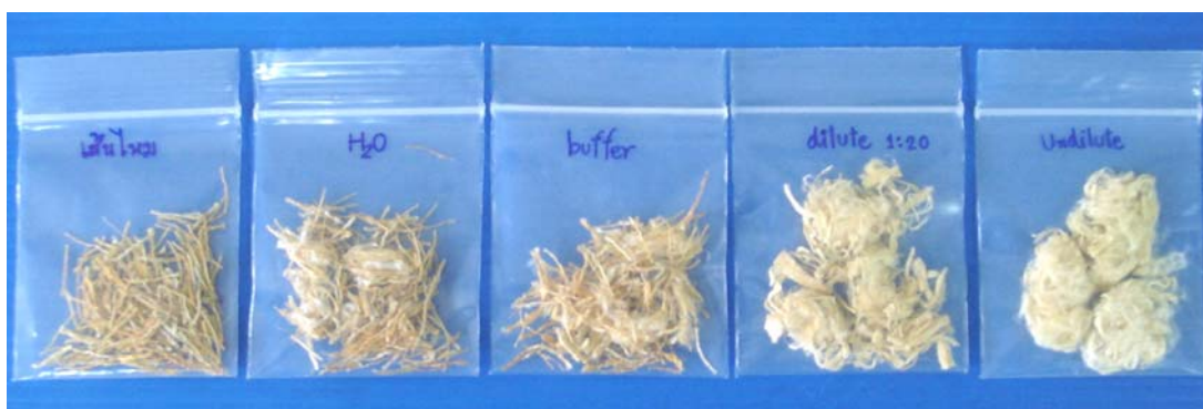
ภาพที่ 20 การเปรียบเทียบการลอกกาว sericin จากเส้นไหมดิบด้วยน้ำกลั่น, glycine-NaOH buffer 50 mM, crude enzyme (ที่ความเจือจาง 1:20) and crude enzyme
