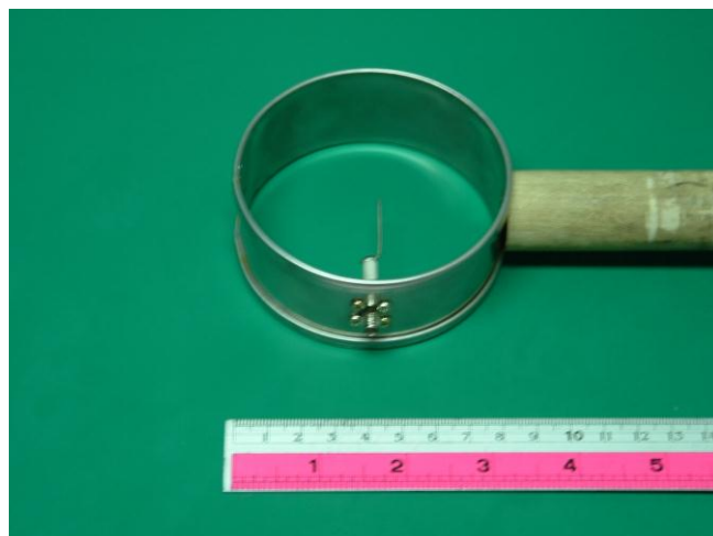
รูปที่ 4.1 รูปถ่ายของสายอากาศวงแหวนวงกลมที่ได้สร้างขึ้นจริง
