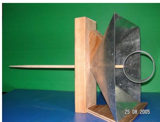
รูปที่ 4.2 รูปถ่ายของสายอากาศตัวสะท้อนแบบพีระมิด
