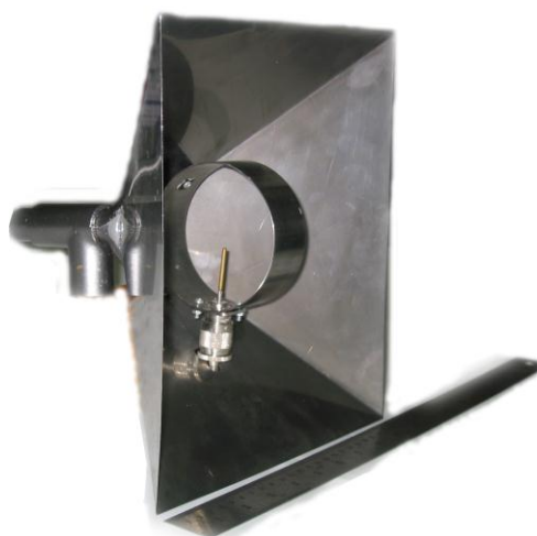
รูปที่ 4.3 รูปถ่ายของสายอากาศตัวสะท้อนแบบพีระมิดป้อนสัญญาณด้วยวงแหวนวงกลม
