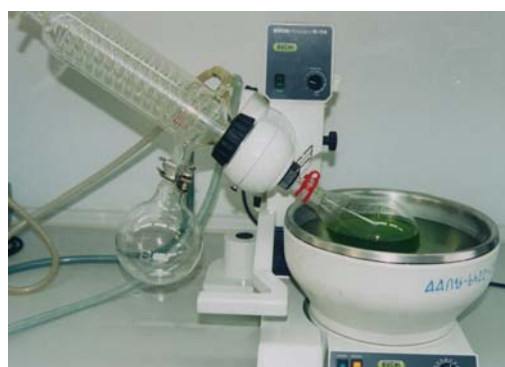
การระเหยเอาตัวทำละลายออกด้วยระบบ สูญญากาศโดยเครื่องrotary evaporator
