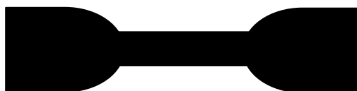
รูปที่ 3.1 ลักษณะชิ้นงานคัมเบลล์ที่นำมาทดสอบ [27]
