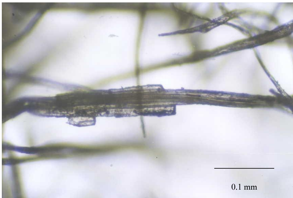
รูปที่ ค-3 ภาพจาก Optical microscope ของเส้นใยไม้ยางพารา ที่กำลังขยาย 100 เท่า
