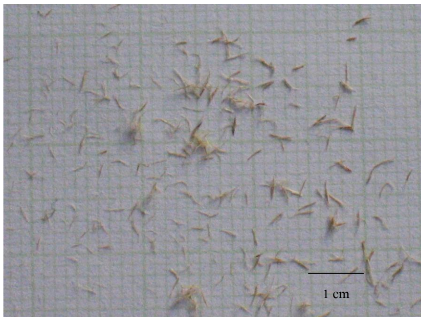
รูปที่ ค-1 ภาพถ่ายแสดงขนาดและความยาวของเส้นใยไม้ยางพารา
