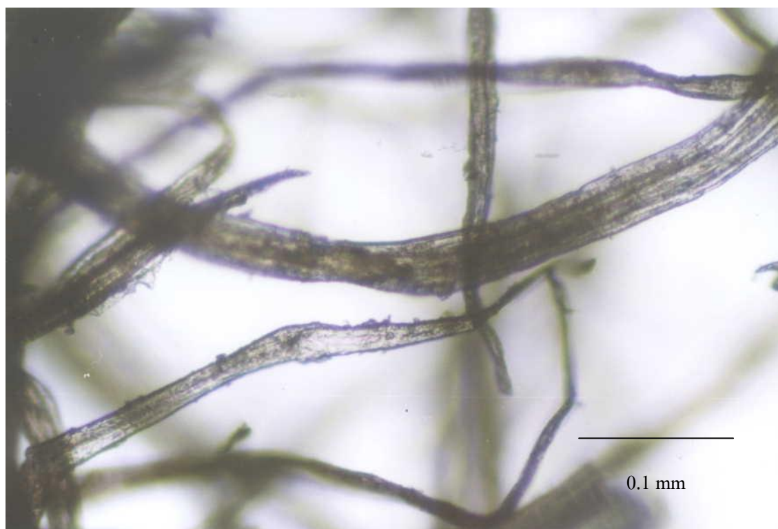
รูปที่ ค-2 ภาพจาก Optical microscope ของเส้นใยไม้ยางพารา ที่กำลังขยาย 100 เท่า
