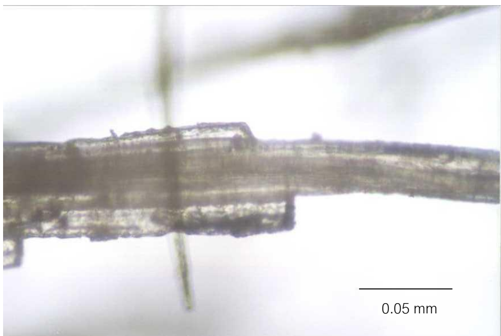
รูปที่ ค-4 ภาพจาก Optical microscope ของเส้นใยไม้ยางพารา ที่กำลังขยาย 200 เท่า
