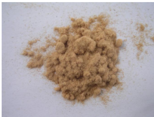
รูปที่ 3.1 รูปถ่ายลักษณะของเส้นใยไม้ยางพาราจากกระบวนการความร้อนเชิงกล
