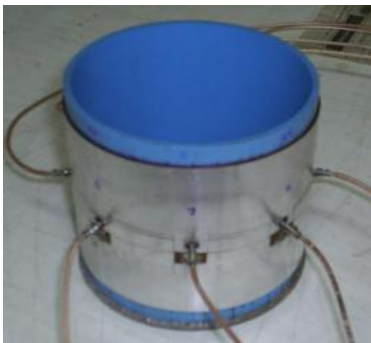
รูปที่ 3.8 ตัวเซ็นเซอร์หน้าตัดกลมที่ใช้ในการทดลอง
