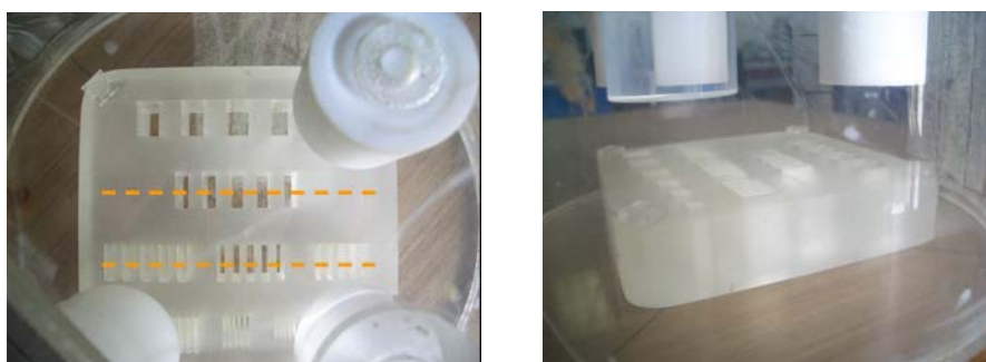
รูปที่ 6.19 แสดงเฟ้นตอม 1 ทำจากพลาสติกอะคริลิก ความหนาโดยประมาณ 2 ซม. ทำการเอ็กซเรย์ตามแนวเส้นประสีส้ม ทั้ง 2 เส้น
