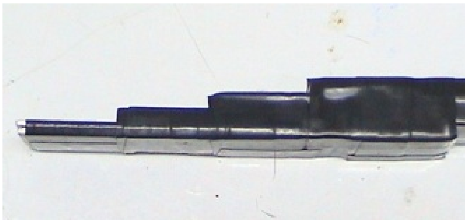
รูปที่ 6.25 แสดงเฟนตอม 3 ทำจากแผ่นอลูมิเนียมมาซ้อนกันเป็นรูปขั้นบันได โดยความหนาของแผ่นอลูมิเนียม 1 มม. จำนวนทั้งสิ้น 8 แผ่น
