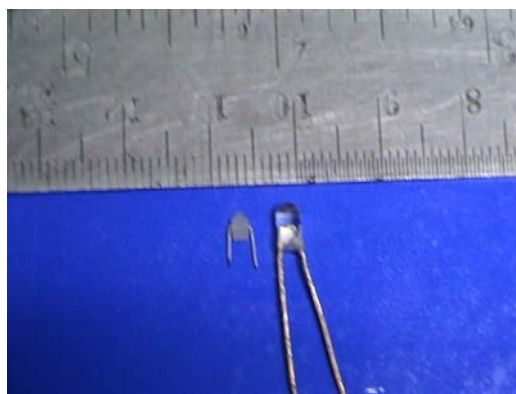
รูปที่ 5.2 แสดงขนาดของโฟโตทรานซิสเตอร์แบบใหม่เทียบแบบที่ใช้ในงานวิจัยเดิม
