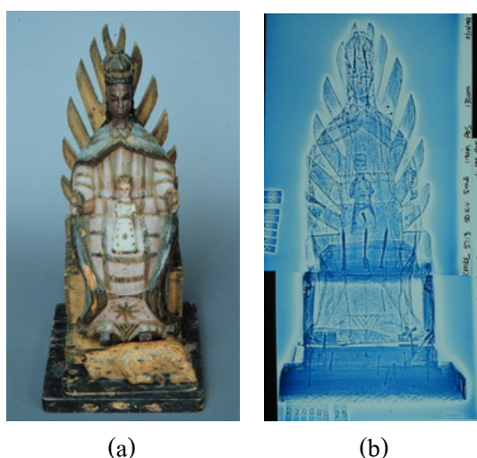
รูปที่ 2.12 แสดงการใช้ Xeroradiography ในการตรวจสอบวัตถุต่างๆ (a) ตัวอย่างวัตถุที่นำมาตรวจสอบ (b) ภาพเอ็กซเรย์ที่ได้จากวิธี Xeroradiography
