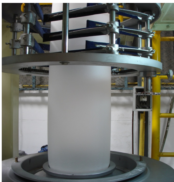
รูปที่ ข-2 ลูกโป่งฟิล์มของพอลิเมอร์ผสมขณะทำการเป่าขึ้นรูป
