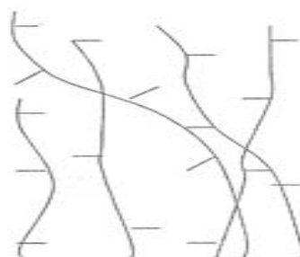
รูปที่ 2.17 โครงสร้างของสายโซ่พอลิเอทิลีนชนิดความหนาแน่นต่ำเชิงเส้น (LLDPE) [24]
