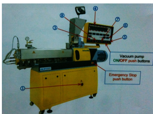
รูปที่ 2.18 ส่วนประกอบเครื่องอัดรีดแบบเกลียวหนอนคู่ [29]
