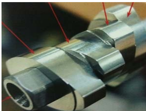
รูปที่ 2.19 ลักษณะการเรียงตัวของเม็ดสกรู [29]
