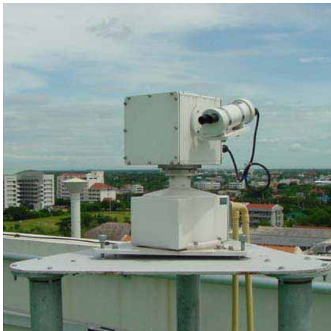
รูปที่ 3.1 เครื่อง sky scanner ซึ่งติดตั้งที่สถานีนครปฐม
