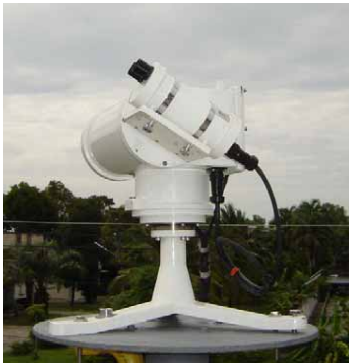
รูปที่ 3.2 เครื่อง sky scanner ซึ่งติดตั้งที่สถานีสงขลา
