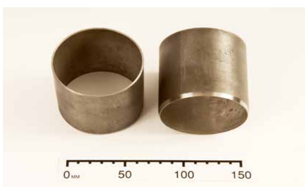
ภาพที่ 15 Soil Core สำหรับเก็บตัวอย่างดิน ที่มา: Anonymous (2006)
