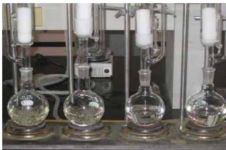
ภาพที่ 22 การสกัดไขมันของปลานิลด้วย Soxhlet
