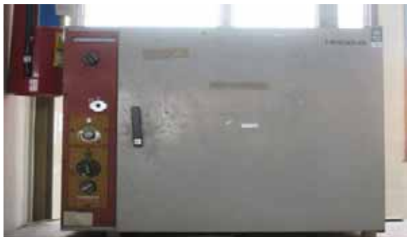
ภาพที่ 16 ตู้อบควบคุมอุณหภูมิได้ที่ 103-105 องศาเซลเซียส
