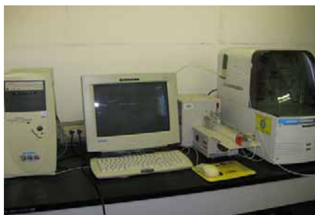
ภาพที่ 21 เครื่อง Total Organic Carbon Analyzer รุ่น Phoenix 8000
