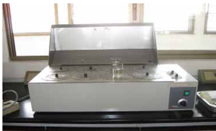
ภาพที่ 23 อ่างน้ำร้อนที่ควบคุมอุณหภูมิที่ 80 °C
