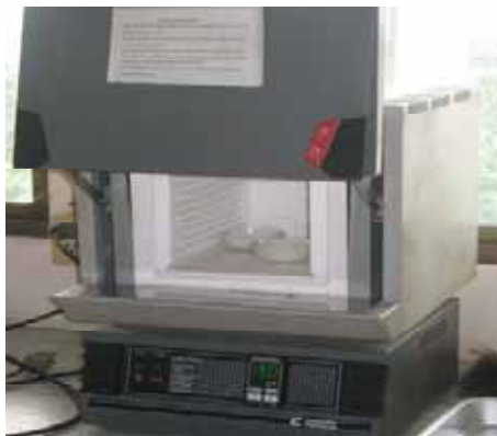
ภาพที่ 17 เตาเผาควบคุมอุณหภูมิได้ที่ 550°C
