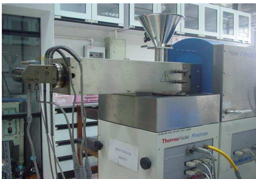
ภาพที่ 25 เครื่องอัดรีดแบบสกรูเดี่ยวประกอบคานาแผ่นที่ใช้ในงานวิจัย
