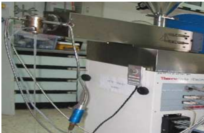
ภาพที่ 24 การไหลของพอลิเอทิลีนความหนาแน่นสูงหลอมเหลวจากเครื่องอัดรีดแบบสกรูเดี่ยว ประกอบคานารูเล็กที่ใช้ในงานวิจัย
