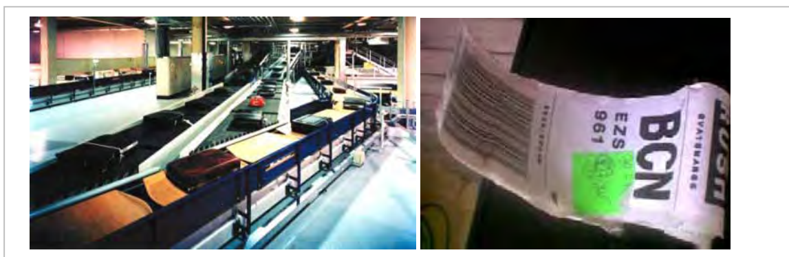
ภาพที่ 235 ระบบสายพานลำเลียงสัมภาระ และการแยกสัมภาระอัตโนมัติด้วยระบบ Barcode
