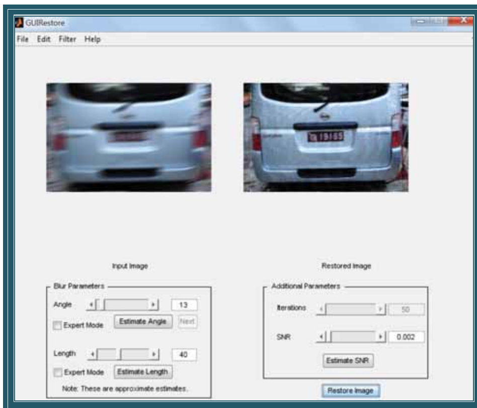
ภาพที่ 88 แสดงภาพที่ได้หลังจากการปรับปรุงภาพด้วยโปรแกรม Restoration
