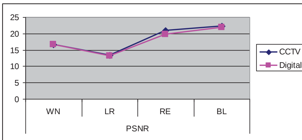
ภาพที่ 73 แสดงการเปรียบเทียบการปรับปรุงภาพพรางมัวเนื่องจากโฟกัสไม่เหมาะสมระหว่างกล้องโทรทัศน์วงจรปิดและกล้องดิจิทัล
