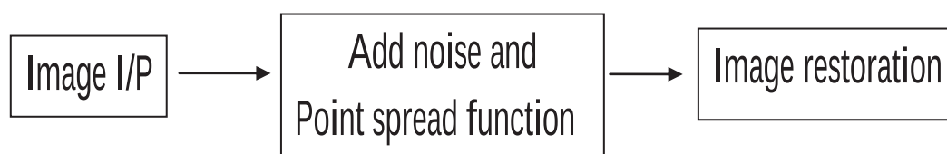
ภาพที่ 60 โครงสร้างของระบบโปรแกรม Image restoration
