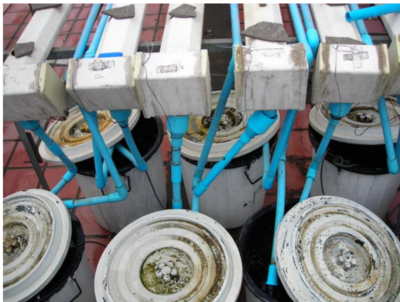
ภาพที่ 3.3 ถังสำหรับใส่สารละลายเพื่อหมุนเวียนให้แก่พืช ขนาด 48 ลิตร
