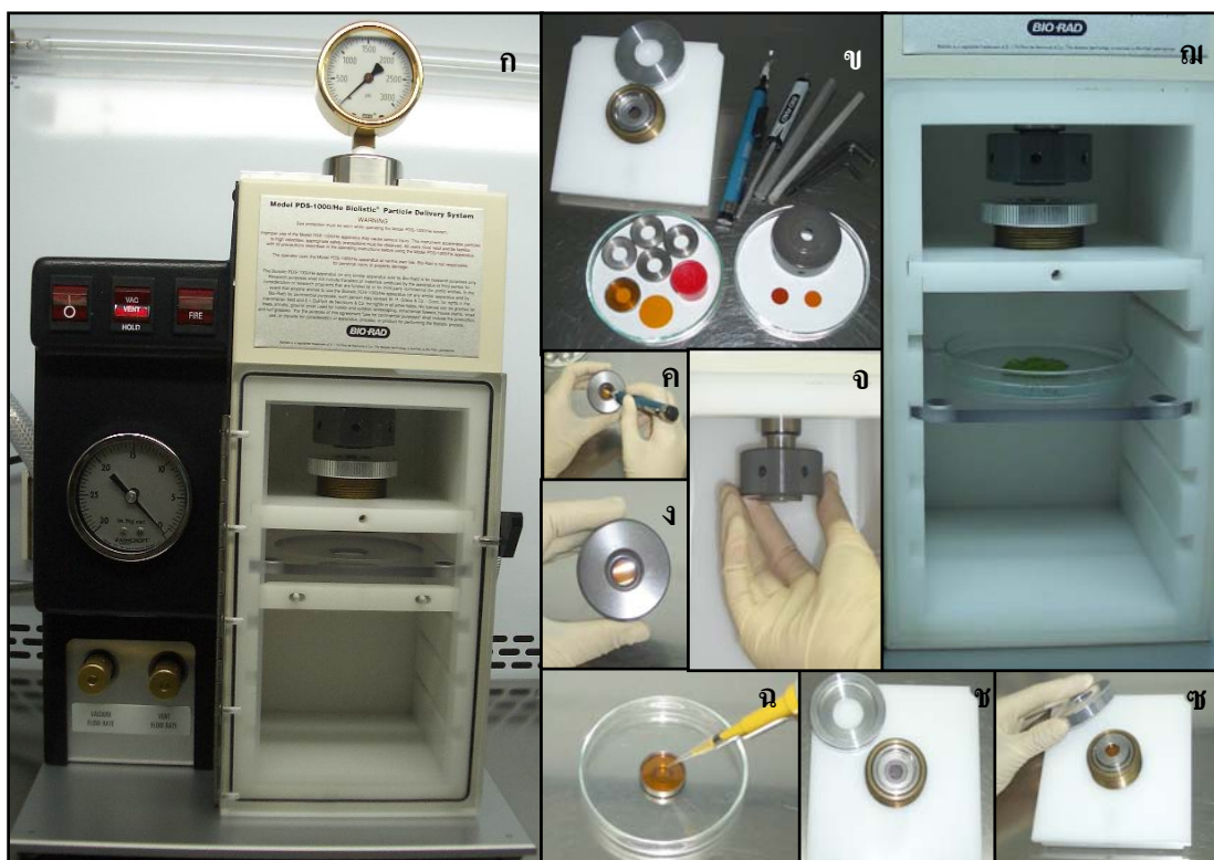
ภาพที่ 6 เครื่องยิงอนุภาคแบบ PDS-1000/He Biolistic® (Bio Rad gun) ก : อุปกรณ์ที่ใช้ในการถ่าย ยิง ข : และขั้นตอนการเตรียมยิงอนุภาคที่ถูกเคลือบด้วยพลาสติกดีเอ็นเอ pUM 75 เข้าสู่ใบ ยาสูบ คือ ค-ง : นำแผ่น rupture disk ใส่ลงใน rupture disk retaining cap จ : นำ rupture disk retaining cap ประกอบกับเครื่องตรงส่วนปลายของ gas acceleration tube ฉ : หยดอนุภาคทองคำที่ถูกเคลือบด้วยพลาสติกดีเอ็นเอลงตรงกลางแผ่น macrocarrier ช : นำตะแกรงลวด (stopping screen) วางบน macrocarrier launch assembly ซ : นำ macrocarrier ที่แห้งมาวางบน stopping screen ในลักษณะคว่ำลง ปิดฝา macrocarrier launch assembly ฅ : ตำแหน่งของ macrocarrier launch assembly และตำแหน่งของ จานเพาะเลี้ยงเนื้อเยื่อที่มีตัวอย่างใบยาสูบอยู่ตรงกลาง โดยสามารถปรับระดับนี้ได้ (6 9 และ 12 เซนติเมตร)
