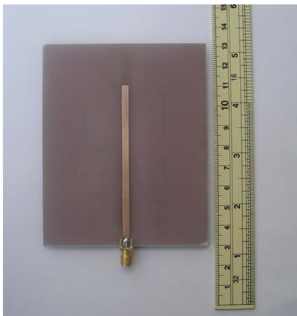
รูปที่ 4.56 โครงสร้างจริงของสายอากาศไมโครสตริปช่องเปิดมุมฉากแบบแถวลำดับ 4 ช่องเปิด ทางด้านหลัง
