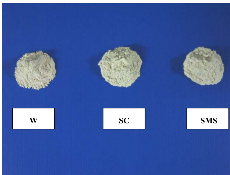
ภาพที่ 4.2 สตาร์ชมันเทศเนื้อสีม่วง (W: สกัดด้วยน้ำ, SC: สกัดด้วยโซเดียมคาร์บอเนตเข้มข้น 0.1 นอร์มอล และ SMS: สกัดด้วยโซเดียมเมตาไบซัลไฟต์เข้มข้น 3.12 มิลลิโมลาร์)
