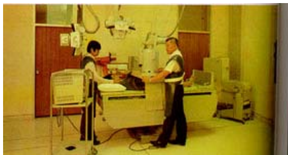
รูปที่ 2.3 เครื่องทำฟลูออโรสโคปีชนิดที่ใช้เครื่องปรับความเข้มของแสงและโทรทัศน์วงจรปิด
