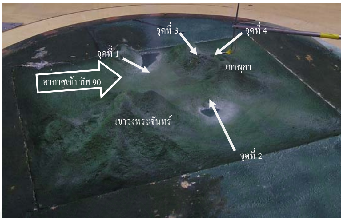
ภาพที่ 7 แบบจำลอง, จุดวัด และทิศทางลมในอุโมงค์ลม
