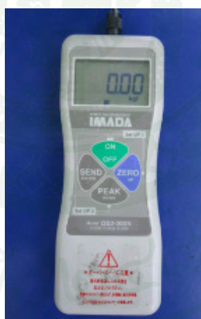
ภาพที่ 28 อุปกรณ์การวัดแรงสำหรับวัดแรงกดบริเวณแผ่นอลูมิเนียมของสายรับส่งสัญญาณ การอ่านเขียนข้อมูล
