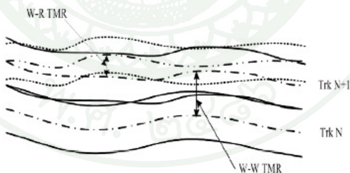
ภาพที่ 13 การเข้าถึงตำแหน่งแทร็คที่ไม่ถูกต้องจากการเขียนและอ่านสัญญาณ
