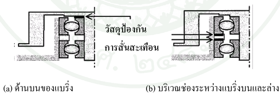
ภาพที่ 21 ตำแหน่งการใส่วัสดุป้องกันการสั่นสะเทือนภายในสปินเดิลมอเตอร์แบบแบร์ริงแบบลูกบอล
