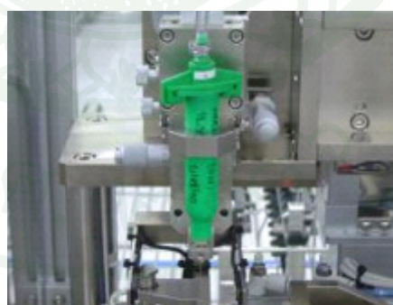
ภาพที่ 26 อุปกรณ์สำหรับหยอดกาวในชุดหัวอ่านเขียน
