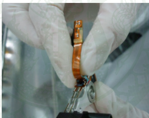
ภาพที่ 51 วิธีการพันตัวเกี่ยวสายรับส่งสัญญาณการอ่านเขียนข้อมูลระหว่างหัวอ่านเขียนกับแผงวงจรให้ยึดกับแผ่นอลูมิเนียม
