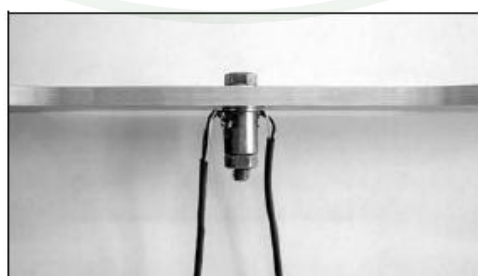
ภาพที่ 5 แสดงการติดตั้งLoad Cell ที่แป้นเกลียวกับสลักเกลียว
