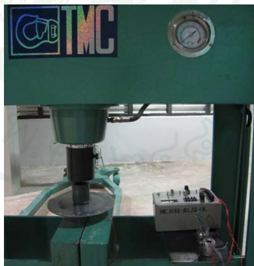
ภาพที่ 26 ขั้นตอนการกดและวัดค่าความเครียด
