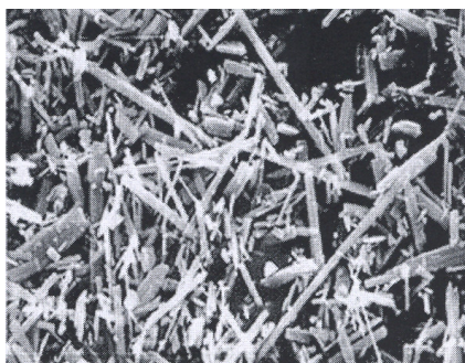
รูปที่ 2.3 รูปร่างผลึกของแคลเซียมซิลิเกตชนิด Wollastonite [11]
