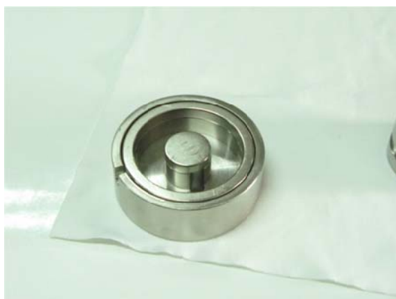
รูปที่ 4.2 แม่เหล็กที่ติดตั้งในเบ้าหล่อเย็น
