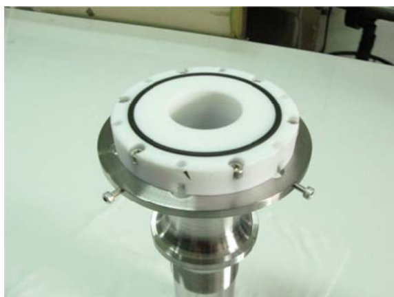
รูปที่ 4.1 เบ้าหล่อเย็นที่ติดตั้งบนฐานรอง
