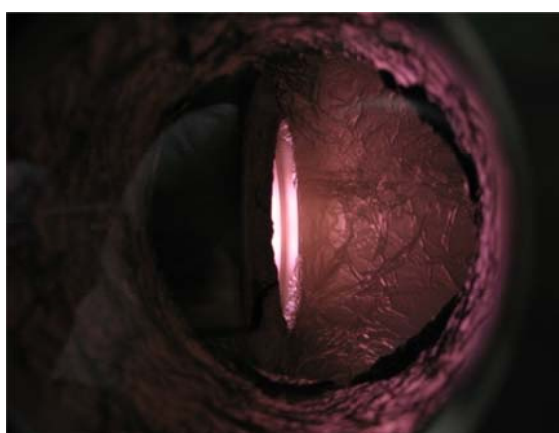
รูปที่ 4.6 การเกิดพลาสมาดีสชาร์จเหนือแผ่นเป้าลุ่มิเนียมของแมกเนตรอนแคโทด
