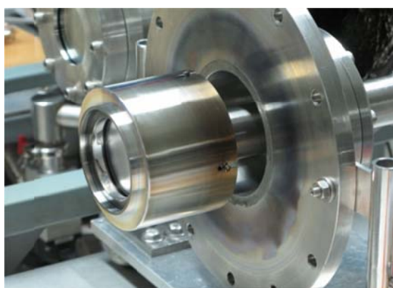
รูปที่ 4.5 แมกเนตรอนแคโทดที่ติดตั้งในระบบสุญญากาศที่ใช้ในการปลูกฟิล์มบาง
