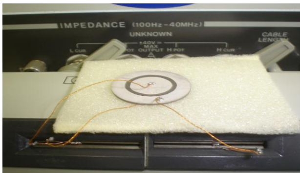
รูปที่ 3.2 การวัดพารามิเตอร์ของเพียโซอิเล็กทริกทรานส์ฟอร์มเมอร์
