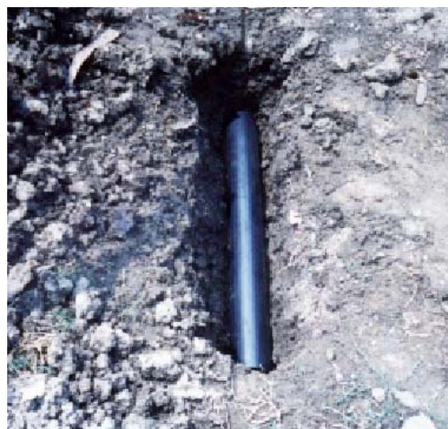
รูปที่ 5.16 ท่อโลหะที่ใช้ทดสอบการป้องกันการผุกร่อนแบบ Impressed Current
