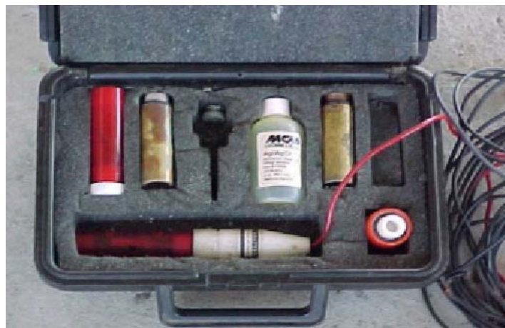
รูปที่ 5.21 หัววัดแบบ \text{Cu}/\text{CuSO}_4 สำหรับการวัดตรวจสอบผลการใช้งานของป้องกันการผุกร่อนของท่อโลหะ
