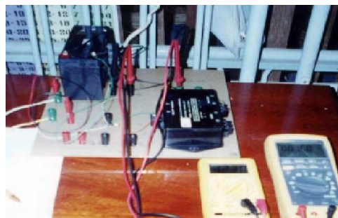
รูปที่ 5.19 การต่อระบบเพื่อทำการทดสอบใช้งานชุดป้องกันการผุกร่อนของท่อโลหะแบบ Impressed Current
