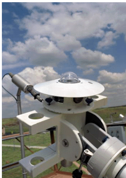
รูปที่ 2.8 เครื่องมือวัดปริมาณรังสีแสงอาทิตย์ที่ตกกระทบลงบนพื้นโลก
