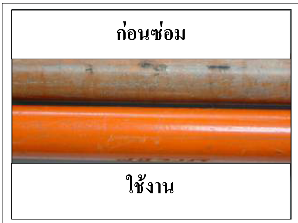
รูปที่ 5.13 แสดงสภาพผิวของ Hot Stick หลังจากการเกิด Flashover
