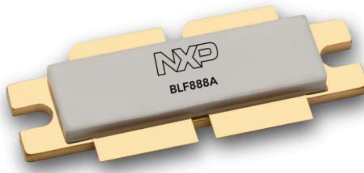
ภาพที่ 4.25 โครงสร้างของ LDMOS RF transistor Power (BLF888A )
