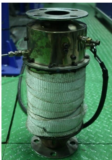
ภาพผนวกที่ ก3 แสดงการติดตั้งฮีทเตอร์ไฟฟ้าเข้ากับ MAIN-CAT
