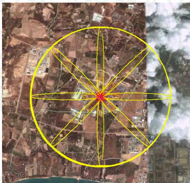
ภาพที่ 15 แผนที่จาก Google Earth แสดงพื้นที่ที่ได้รับผลกระทบของการกระจายความเข้มข้นของไอรกดที่เกิดจากการรั่วไหลของกรดอะเซติกออกจากถังเก็บขนาด 825 \text{ m}^3 ที่เกิดขึ้นในเวลากลางคืนเท่านั้น (วงรีภายในวงกลมแสดงถึงพื้นที่ที่ได้รับผลกระทบจากไอรกดเข้มข้น \geq 5 พีพีเอ็ม ที่ทิศทางลมต่างๆ)
