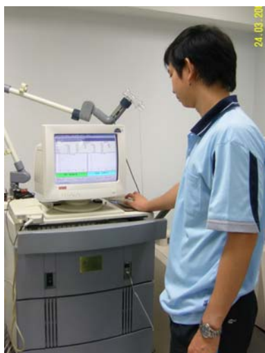
ภาพผนวกที่ ข3 แสดงขั้นตอนการ Calibrate standard O 2 และ standard CO 2
