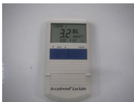
ภาพผนวกที่ ๑1 แสดงเครื่องตรวจ Blood Lactate ยี่ห้อ Roche รุ่น Accutrend Plus Meter
