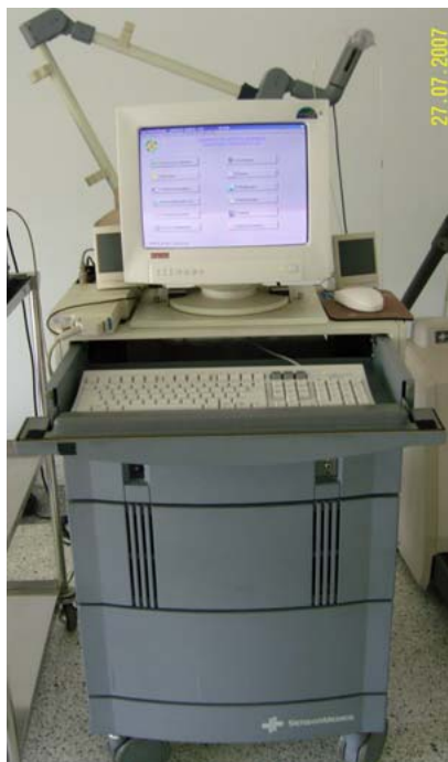
ภาพผนวกที่ ข1 เครื่องวิเคราะห์ก๊าซและชุดอุปกรณ์ Metabolic Cart ยี่ห้อ Sensor Medics รุ่น Vmax 229 Series ประเทศสหรัฐอเมริกา
